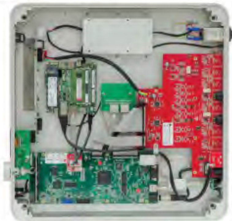
L'interno evidenzia la costruzione modulare dell'apparecchio. La sezione base è raccolta nella grande scheda rossa posta verso il retro dell'apparecchio. La sezione alimentatrice è coperta dal pannello in metallo visibile nella parte alta della foto.
