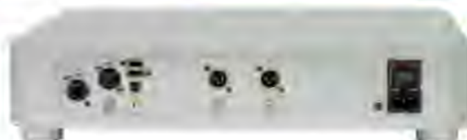
I collegamenti digitali sono posti nella parte sinistra del retro; mentre le uscite analogiche bilanciate e sbilanciate sono di centro.
