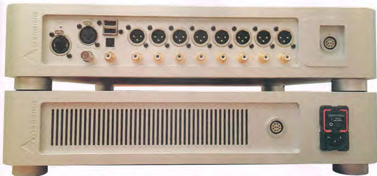
Il pannello posteriore del NADAC a otto canali mostra una pletora di connettori bilanciati e non, rispetto al ben più semplice Power.
