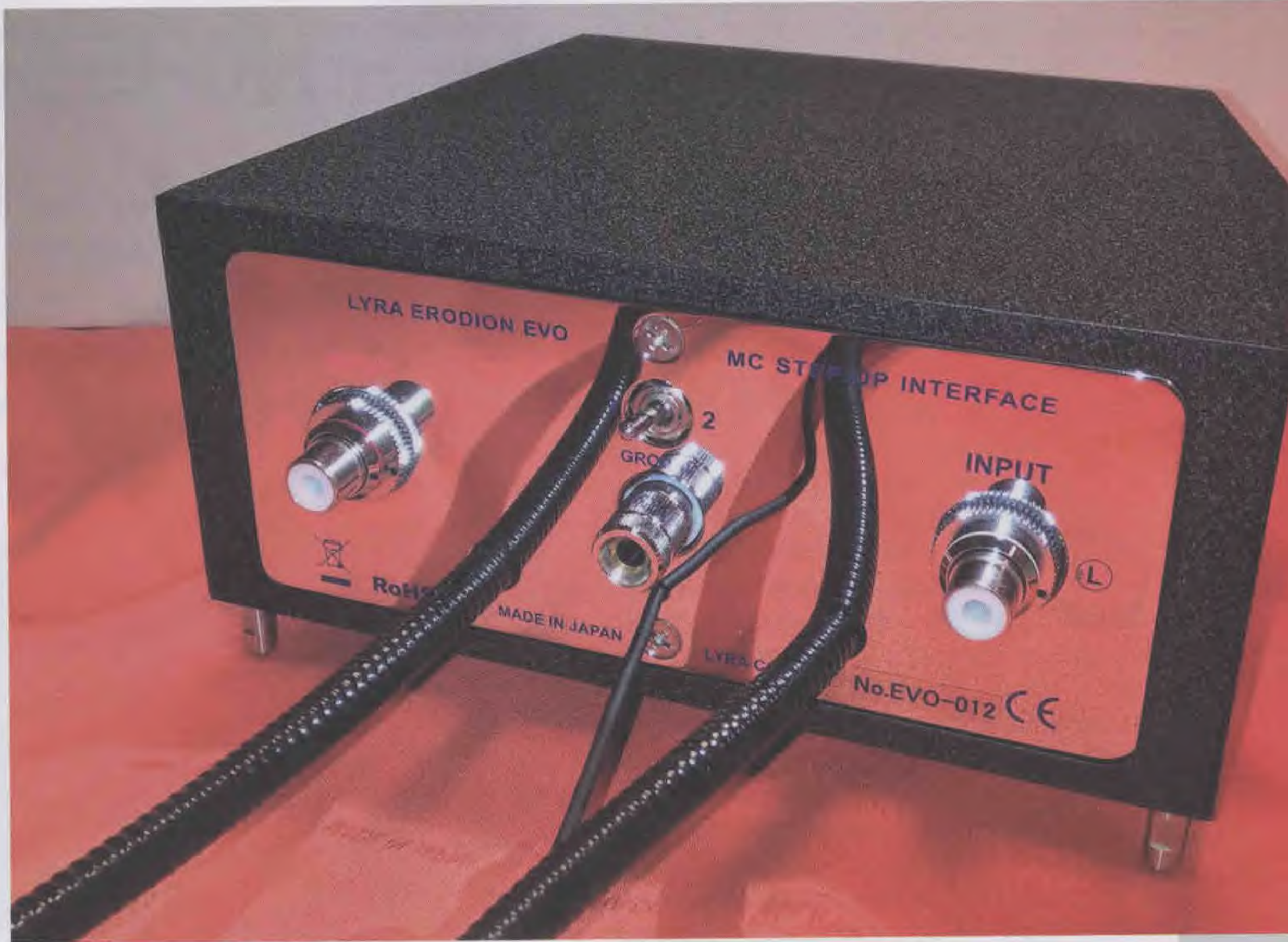
Il telaio, rigido e pesantissimo, poggia su tre punte di acciaio inossidabile.
