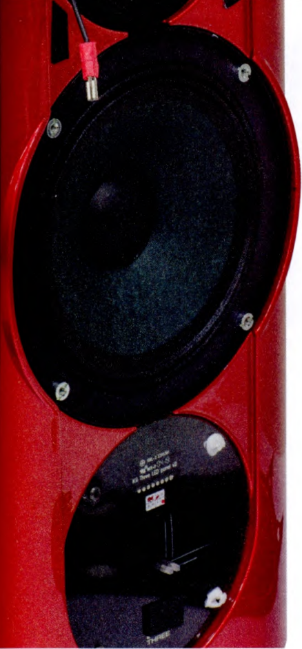
Il midrange da 150 mm assomiglia ad un Peerless nella realizzazione del cestello e del magnete largo e non molto alto. Notare la sospensione a due corrugazioni per minimizzare le colorazioni in gamma media.
