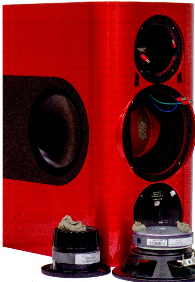
Entrambi i trasduttori frontali sono bloccati alla piccola parete posteriore tramite interposizione di stucco morbido che smorza eventuali inneschi di risonanza della struttura meccanica degli altoparlanti.
