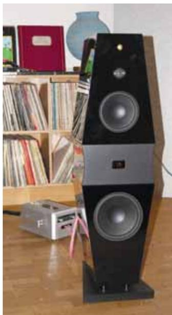
Il modello Volterra, con il mid woofer caricato in bass reflex ed il woofer in sospensione pneumatica. Più in alto si nota il supertweeter.
