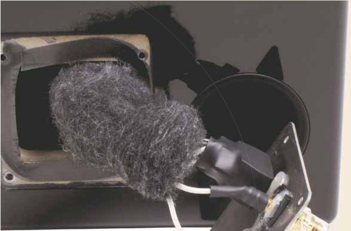
*I vari cablaggi del C5 sono ben protetti da elevate quantità di materiale fono assorbente.*
