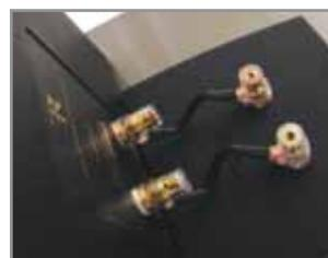
I connettori sono di buona qualità e piuttosto diffusi. Da notare la finitura dello spezzone di cavo che collega il satellite al sub woofer.
