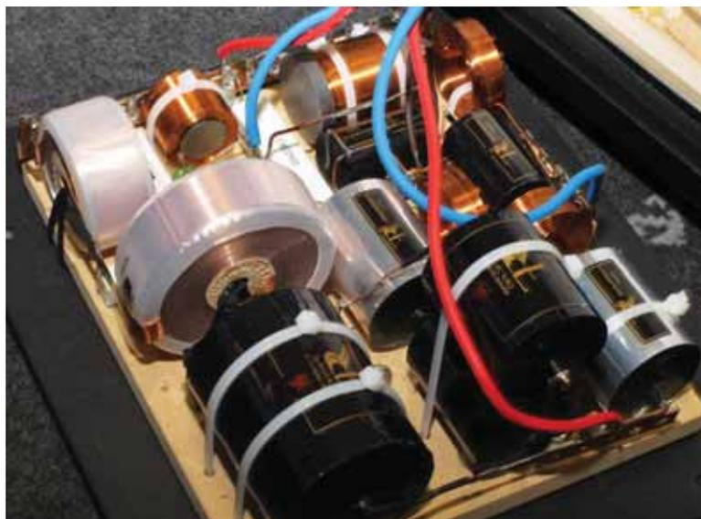
Particolare del circuito crossover riguardante la sezione di filtraggio midwoofer-tweeter-super tweeter. Da notare le induttanze in film foil usate per il passa banda del midwoofer assieme ai pregiati condensatori in poli-propilene utilizzati sia sul midwoofer che per il taglio del tweeter.
