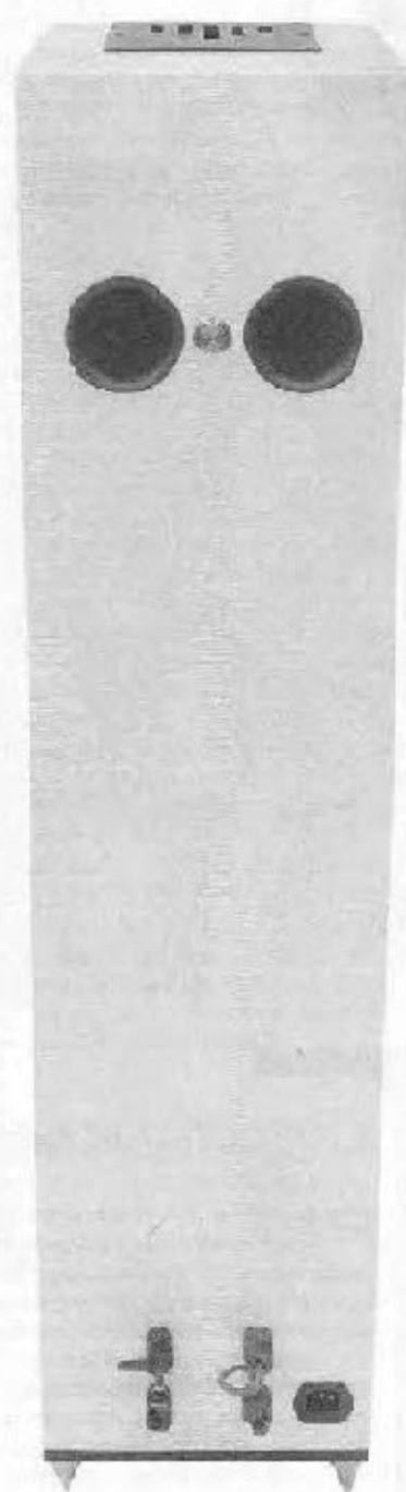
Sul pannello posteriore, oltre ai doppi morsetti per i cavi di potenza, intanto, in basso, la presa EC che alimenta il tweeter Corona o, in alto, il relativo pulsante di accensione posto tra i condotti per la circolazione dell'aria nel volume del tweeter.
