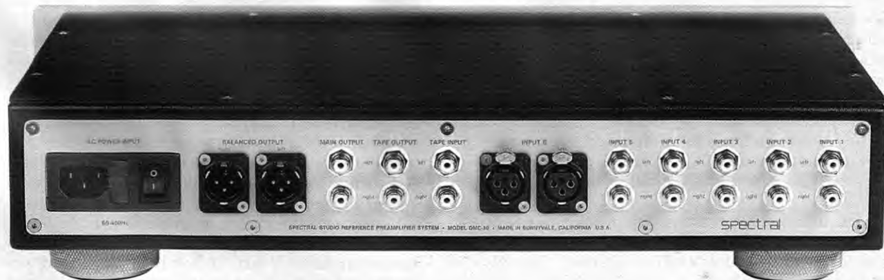
Il pannello posteriore con il nuovo ingresso bilanciato pensato specificamente per le sorgenti digitali.
