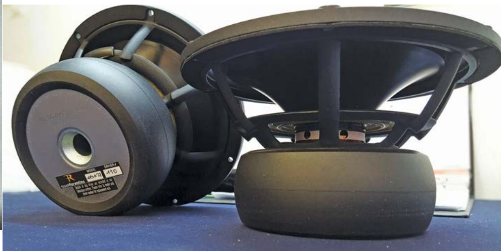
I woofer sono due ScanSpeak da 8 pollici con membrana in alluminio.
