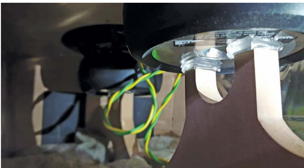
Per evitare vibrazioni dei complessi magnetici questi sono incollati ai rinforzi interni.
