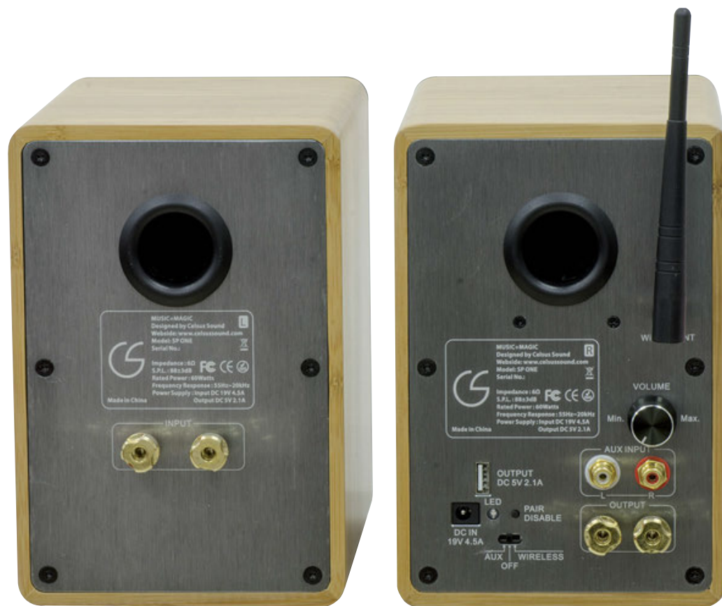
Il pannello posteriore del diffusore del canale destro racchiude tutti i controlli del sistema: manopola del volume, in posizione non ottimale al di sotto dell'antenna del wireless, il tasto di accensione, che determina anche quale connessione usare (se la RCA o il Bluetooth) ed infine il tasto di accoppiamento/disaccoppiamento alla sorgente. È presente anche una presa USB per la ricarica della sorgente.
