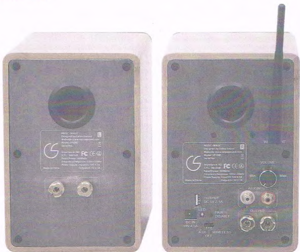
Il pannello posteriore del diffusore del canale destro racchiude tutti i controlli del sistema: manopola del volume, in posizione non ottimale al di sotto dell'antenna del wireless, il tasto di accensione, che determina anche quale connessione usare (se la RCA o il Bluetooth) ed infine il tasto di accoppiamento/disaccoppiamento alla sorgente. È presente anche una presa USB per la ricarica della sorgente.
