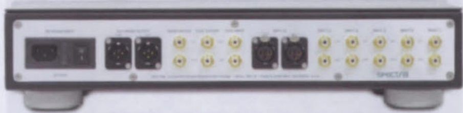
Il pre DMC 30SC adotta lo stesso telaio del DMC 30SV, comprese le connessioni XLR sul pannello posteriore, che in questo caso sono tuttavia disabilitate.
