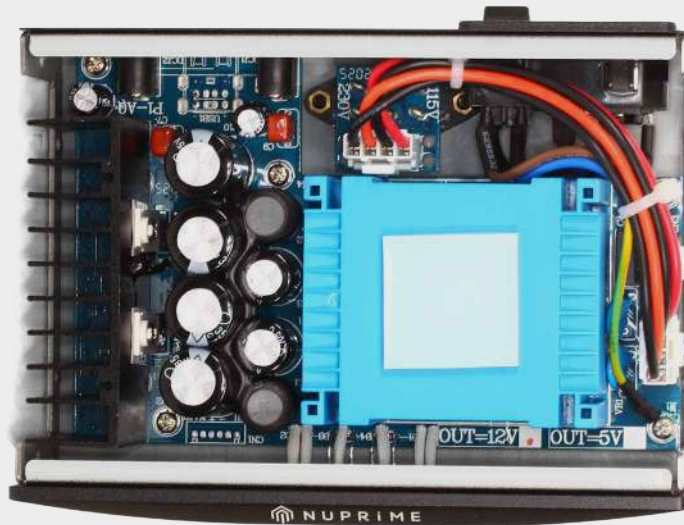
L'alimentatore esterno impiega un trasformatore incapsulato, un ponte a diodi separati e stabilizzatori di tensione a 12VDC in uscita. È inoltre dotato di filtri EMI antidisturbo e di protezione dalle sovratensioni. Il gruppo di condensatori utilizzato, se ne apprezzano una serie di quattro da 3.300uF da 35V ciascuno, raggiunge un valore complessivo molto alto che abbinato alla filtratura offre un buon isolamento dalla rete.
