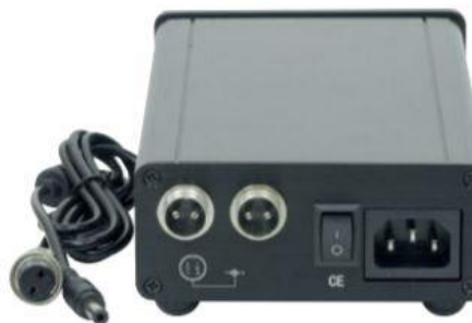
L'alimentatore stabilizzato lineare opzionale promette secondo il costruttore prestazioni migliori. È basato su un trasformatore toroidale e ha il filtro EMI antisturbi in ingresso e CLC in uscita.
