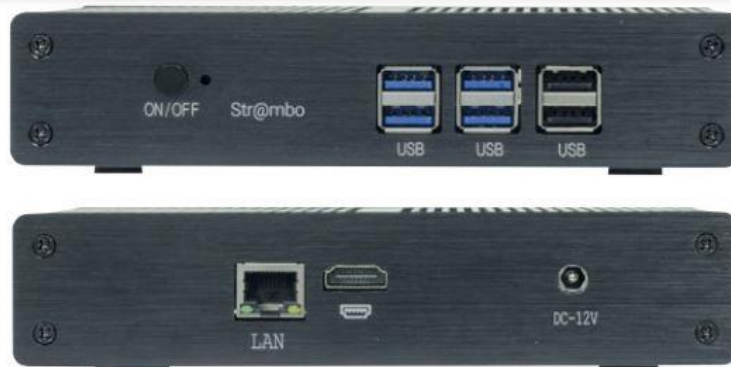
Ci sono connessioni sia sul pannello posteriore che su quello anteriore. Il frontale offre tutte le prese USB-A più il tasto di accensione mentre sul lato opposto c'è la presa Ethernet, l'ingresso dell'alimentazione e un HDMI per il collegamento eventuale ad un monitor.
