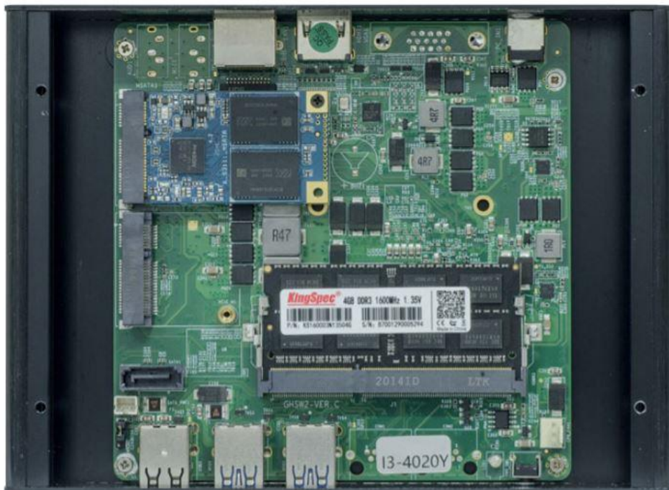
Lo Str@mbo è costruito sulla base di mini PC fanless molto robusti, studiati per lavorare continuamente in condizioni disagiate. L'interno mostra la scheda madre con hard disk SSD e memorie RAM sostituibili mentre il processore Intel si trova sull'altro lato della scheda rispetto alla foto, a contatto dello chassis per dissipare il calore.
