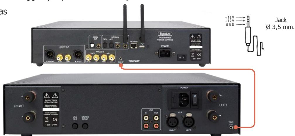
Quando il sistema è in funzione, il pulsante ON/OFF del vostro amplificatore di potenza deve rimanere in posizione OFF (0). Se l'interruttore è in posizione ON (I), l'amplificatore funzionerà ma non la
