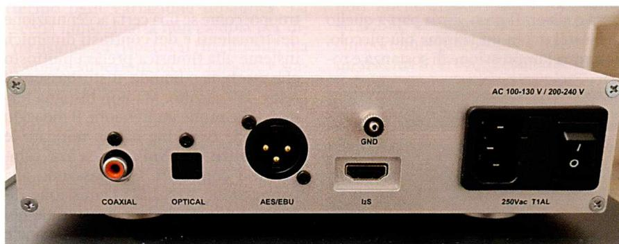
Il NuPrime offre anche il collegamento I<sup>2</sup>S con connettore HDMI e una presa di massa per la messa a terra del telaio. Cosa chiedere di più a un giraCD?
