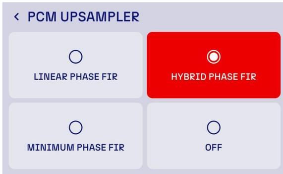
**PCM UPSAMPLER** – Hai la possibilità di scegliere uno dei filtri Rockna a risposta impulsiva finita o di disattivare l'upsampler interno. Ogni impostazione può offrire un'esperienza di ascolto diversa e può essere scelta in base alle preferenze personali e alle caratteristiche specifiche della tua configurazione audio.
